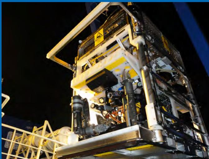
Der RS DIVING Panther-XT Plus ist hochwertig ausgestattet für verschiedenste Aufgaben, wie z.B. Untersuchungen, Pipeline Inspektionen, Bergungen, Kampfmittelräumung, Reinigungen, Baggerarbeiten und leichte IRM (Inspection, Repair and Maintenance) bis zu einer Tiefe von 1.000 Metern.
